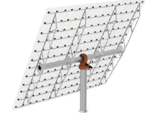
天聚塔式光热双轴跟踪系统，突破校准、安装、运维三大行业难题，其搭载业内独创的智能传感自适应系统，始终保证全生命周期的持续高精度，消除定期校正导致的效能下降。高度的自适应性，大大降低地理环境对安装的要求影响。外加模块化预设组装，使安装效率提升 20% 以上。自研双轴回转减速机，扭矩更大，稳定性更强，外加优异的结构设计，整体系统可抵抗 12 级以上大风。同时独立运行机制，并行控制，系统之间不会相互影响，结合智能传感自适应系统，不受结构变形、地基沉降等因素影响，降低运维成本，提高整体效能。
